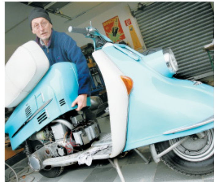
Schrauber gefragt: Jürgen Berg hat Sitz und Verkleidung seines Heinkel Tourist abgenommen und den Motor frei gelegt.
