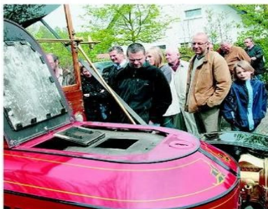
Kesselkappe: Unter dem was heute üblicherweise die Motorhaube ist, steckt der Dampfkessel, befeuert mit Petroleum.
