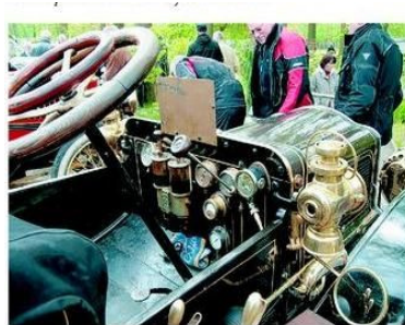
Kompliziert: Viele Hebel, Stellräder und Instrumente muss der Fahrer bedienen und ablesen können. Dennoch sollen die Steamer, wie dieser White von 1904, einfach zu fahren sein.
